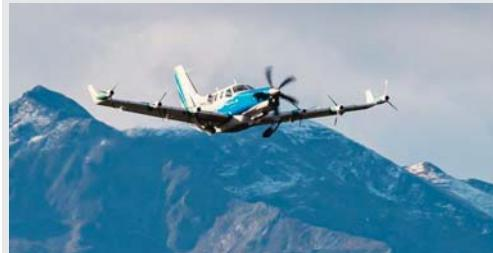
L'EcoPulse, un démonstrateur d'avion à propulsion hybride-électrique distribuée, destiné à tester cette technologie susceptible de contribuer à la réduction de l'empreinte carbone de l'aviation, a effectué son premier vol, ont annoncé mardi Airbus, Safran et Daher. L'appareil a décollé de l'aéroport de Tarbes (France) le 29 novembre pour un vol d'une heure quarante, selon un communiqué conjoint.
