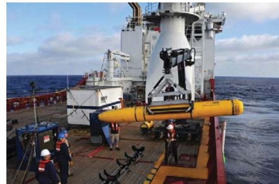
plongée, les données collectées par le sonar de l'appareil, qui a la forme d'une torpille de près de 5 mètres de long, sont collectées à bord de l'Ocean Shield, un navire australien, et analysées pour voir si quelque chose d'anormal a été détecté sur le lit de l'océan.
